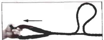
Il giunto della fune tiene saldamente quando la tensione è pari su entrambi i lati dell'asola.
