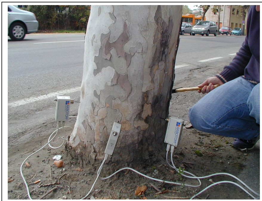
Foto 3.2 Applicazione dei sensori del tomografo ad una pianta
