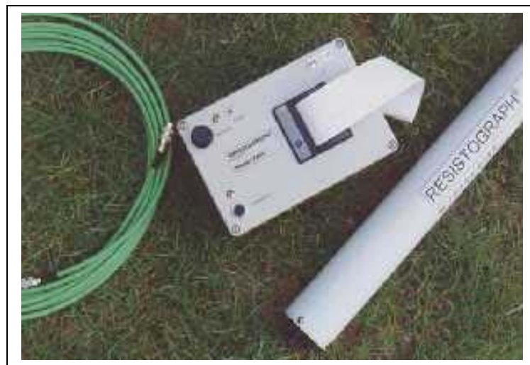
Figura 3.10 Il Resistograph usato nello studi
