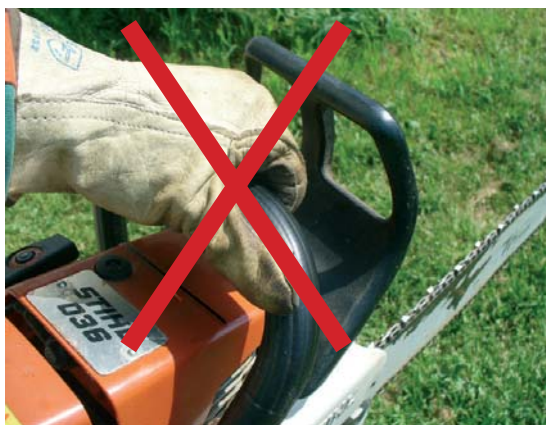
Foto 57 Errata impugnatura, con pollice aperto, della maniglia anteriore della motosega
