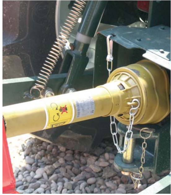
Foto 34b Albero cardanico protetto
