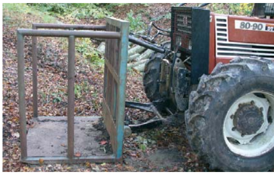
Foto 87 Particolare di una gabbia per l'esbosco a soma di legna da ardere
