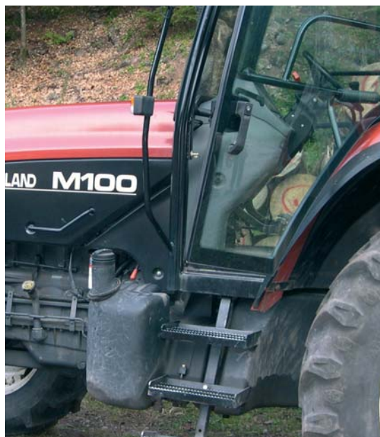
Foto 30 Scalino antiscivolo e maniglia di appiglio
