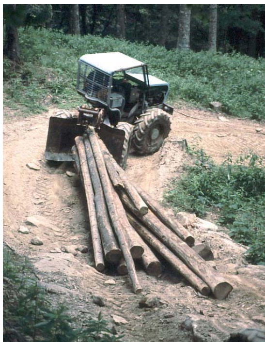
Foto 80 Esbosco a strascico con skidder
