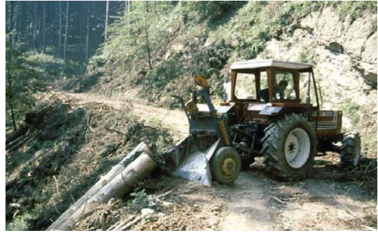
Foto 78 Trattore con verricello carrellato per esbosco a semistrascico
