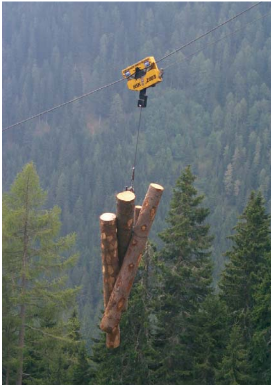
Foto 88 Carrello di teleferica per esbosco via cavo
