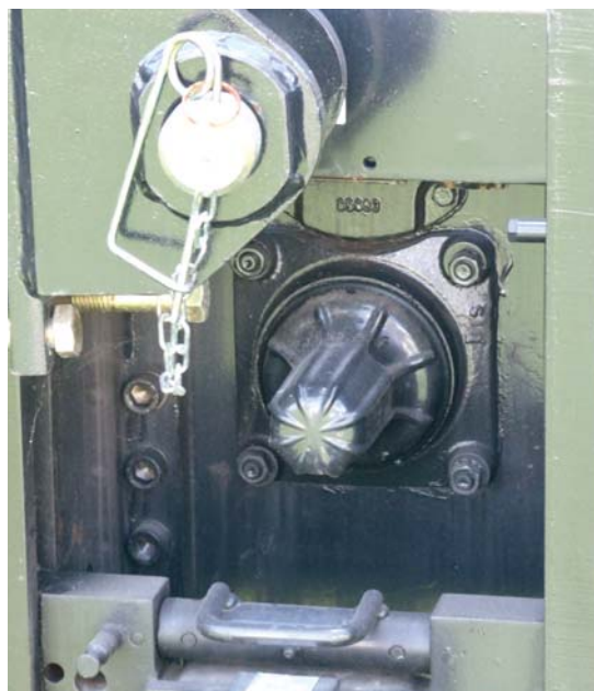
Foto 31 Cappuccio di protezione dell'albero scanalato
