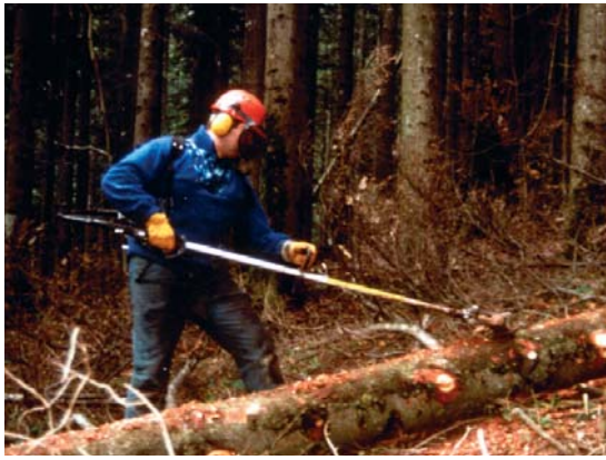
Foto 62 Testa scortecciatrice applicata all'asta di un motodecespugliatore portatile
