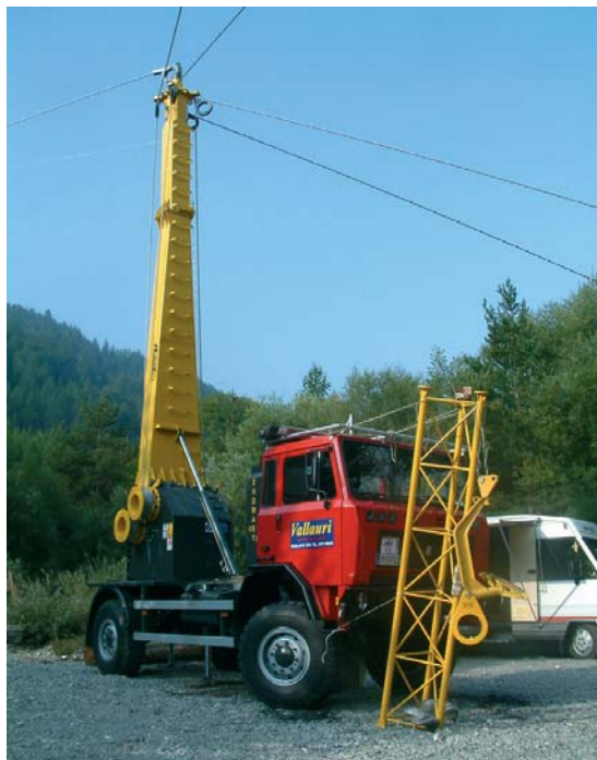
Foto 91 Gru a cavo con stazione motrice mobile allestita su autocarro
