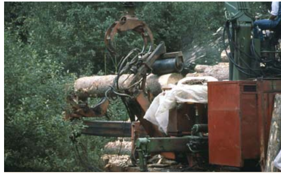
Foto 100 Scortecciatrice a testa fresante
