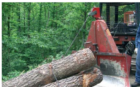
Foto 68 Verricello portato e applicato sull'attacco a 3 punti del trattore
