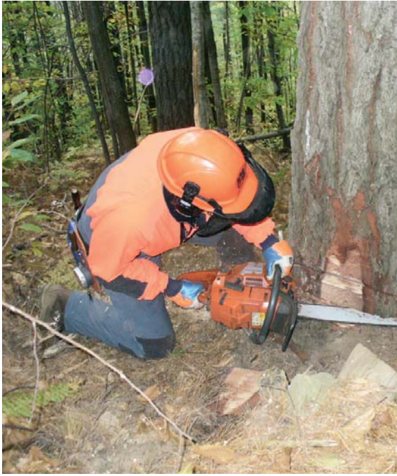
Foto 13a Posizione di abbattimento corretta
