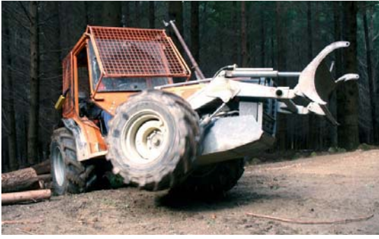
Foto 77 Impennamento del trattore durante l'esbosco a strascico
