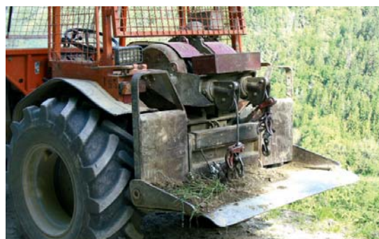
Foto 69 Verricello montato fisso
