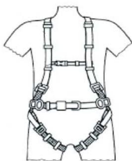
Figura 4 Imbracatura anticaduta con cintura di posizionamento
