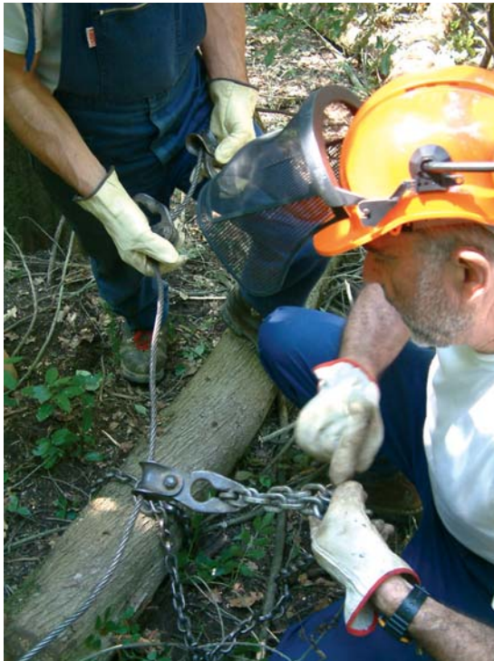
Foto 66 Dettaglio di un gancio scorrevole o chocker
