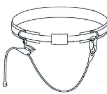
Figura 5 Cintura e cordino di posizionamento
