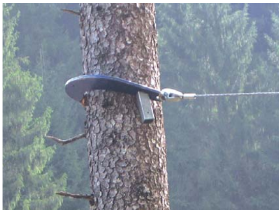
Foto 53 Uncino per afferrare la pianta da atterrare con il paranco
