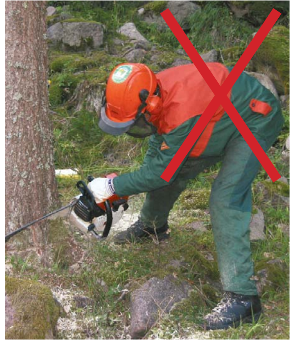
Foto 13b Posizione di abbattimento scorretta
