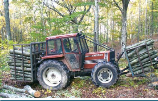
Foto 86 Esbosco con trattore allestito con gabbie per la legna corta
