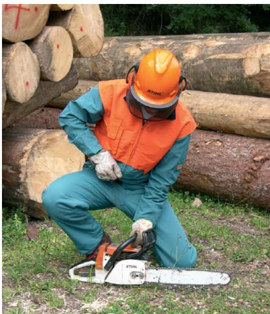
Foto 37a Corretta messa in moto a terra della motosega
