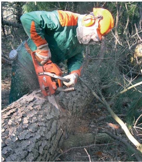
Foto 47 Taglio di sezionatura con la motosega appoggiata ai ramponi
