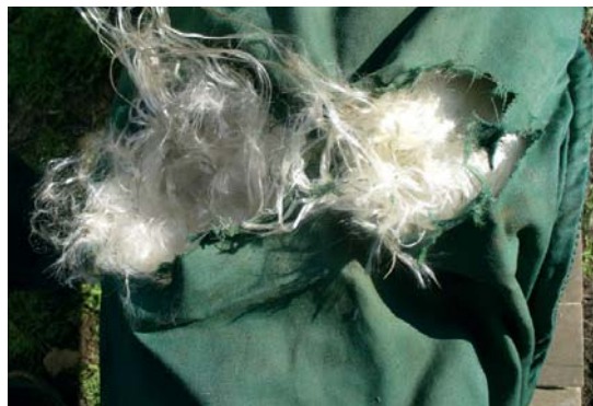
Foto 20 Pantaloni anti-taglio lacerati da catena di motosega
