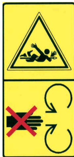
Foto 33 Pittogramma relativo al pericolo di impigliamento e trascinamento
