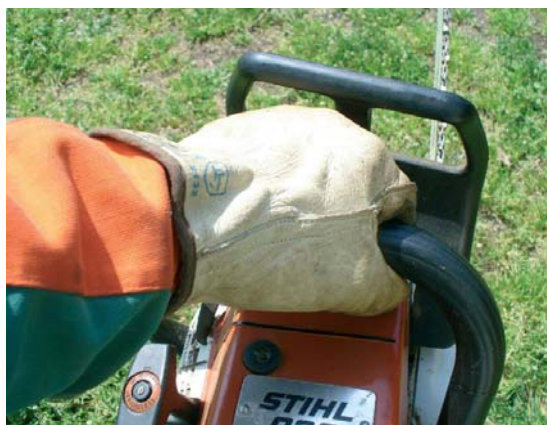
Foto 58 Corretta impugnatura, con pollice chiuso, della maniglia anteriore della motosega
