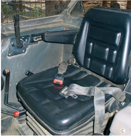
Foto 10 Sedile con ammortizzatore (di trattore)
