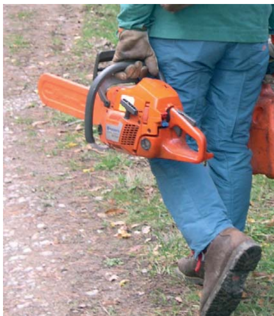
Foto 38b Corretto trasporto della motosega con copribarra
