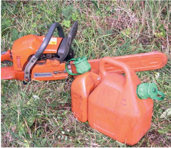
Foto 14a Tanica di sicurezza per rifornimento in bosco
