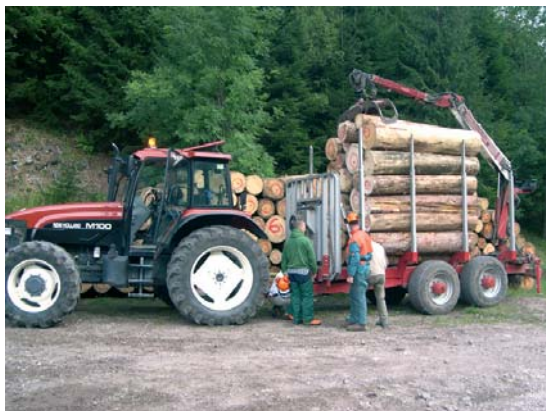
Foto 84 Trattore con rimorchio dotato di gru idraulica
