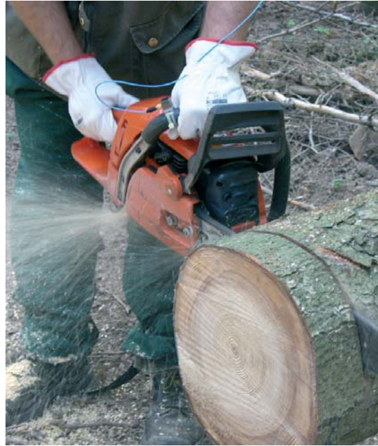
Foto 9 Misurazione delle vibrazioni della motosega
