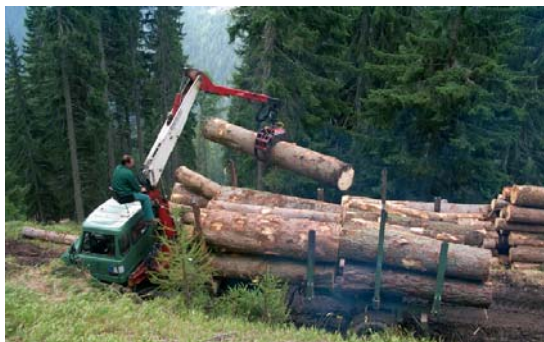
Foto 101 Carico di legname su rimorchio con gru idraulica
