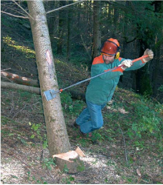
Foto 46 Atterramento di una pianta appoggiata con l'aiuto di una leva giratronchi
