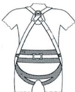
Figura 4 Imbracatura anticaduta con cintura di posizionamento
