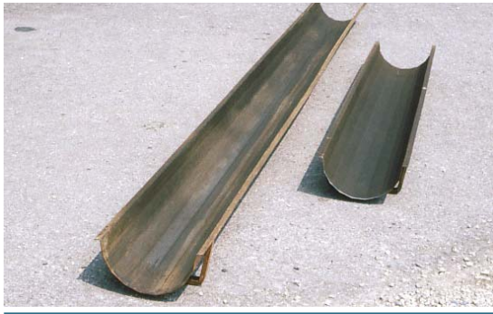
Foto 74 Canalette in metallo
