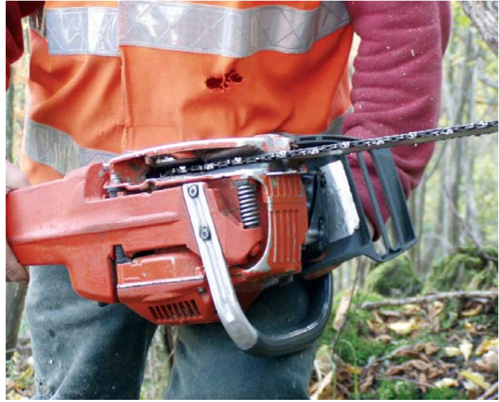
Foto 11 Ammortizzatori presenti nel corpo macchina della motosega
